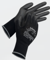
Type : unipur 6639 Material : PA Coating : PU EN 388:2016 : 4 1 3 1 X
