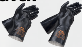
Type : rubiflex ESD NB27A, rubiflex ESD NB35A Material : Interlock katun, Karbon Coating : NBR Standard : EN 388:2016 (2 1 1 1 X), EN ISO 374-1:2016/Type A (J K N O P T), EN 407:2020 (X 1 X X X X), EN 16350:2014)
